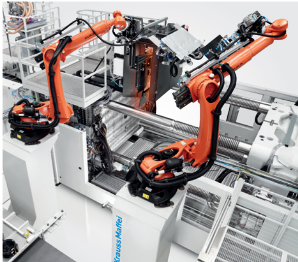
Zwei Roboter entkoppeln das Aufheizen des Organoblechs und die Entnahme des Fertigteils – für kurze Zykluszeiten.
