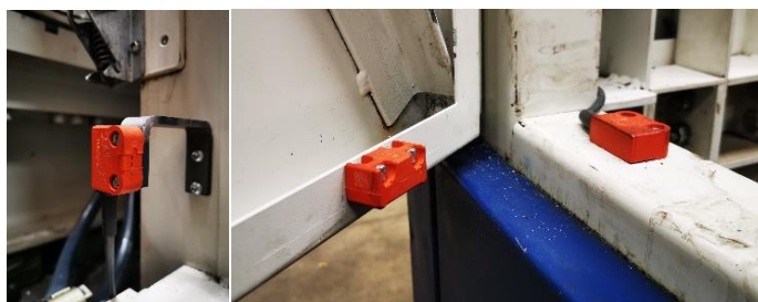
Beispiele für das Not-Aus 2-Kanal-Sicherheitskonzept mit berührungslosen Schutzschaltern an allen Türelementen
