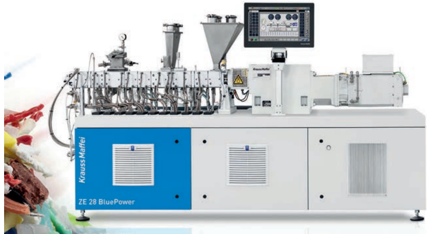
Bild 3. Der Zweischnckenextruder ZE 28 BluePower macht aus dem Sekundär-Rohstoff neues und technisch aufgewertetes Granulat (© KraussMaffei)
