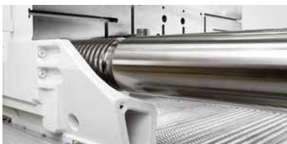
Des patins de guidage à la dynamique optimisée offrent une protection du moule la plus grande possible
