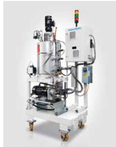
Farbdosiersystem FD: Frequenzgeregelter Dosierpumpe
