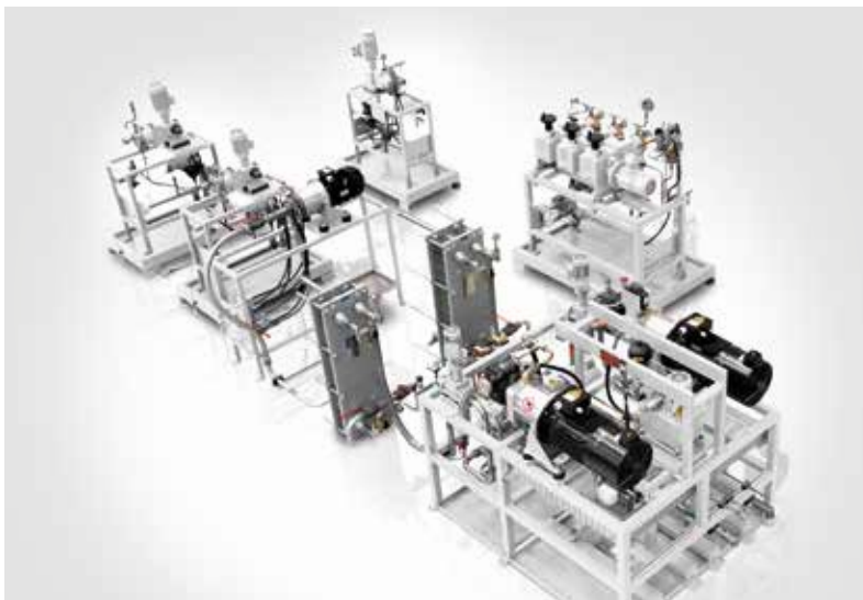
Dosiermaschine für eine Doppelbandanlage mit sechs Komponenten
