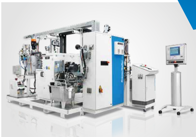
Dosiermaschine RimStar RTM mit Temperierkabine (Maschine mit umfangreicher kundenspezifischer Ausstattung)
