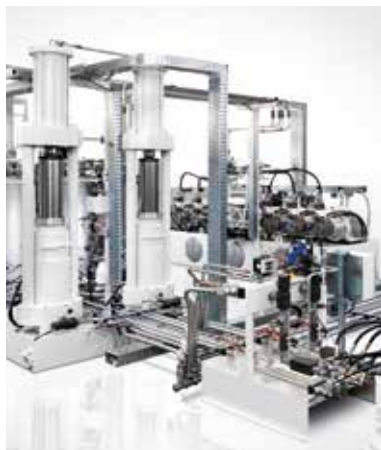
Dosiermaschine Comet mit hydraulisch angetriebenen Kolben
