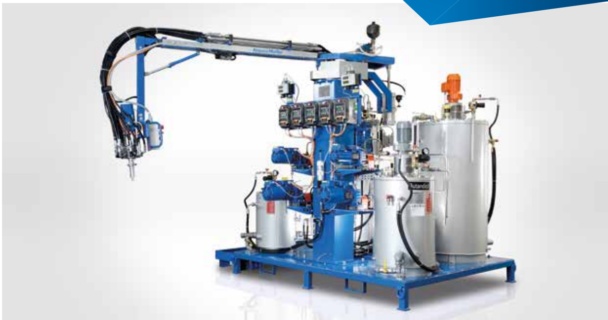
Baureihe F für das Reaktionsgießen mit Niederdruck (kleinere Austragsmengen)
