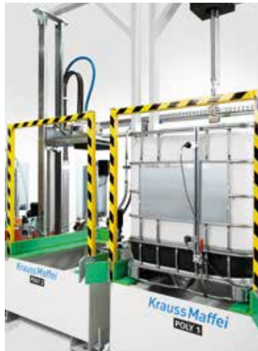
Containerstation zur Vorkonditionierung der PUR-Komponenten
