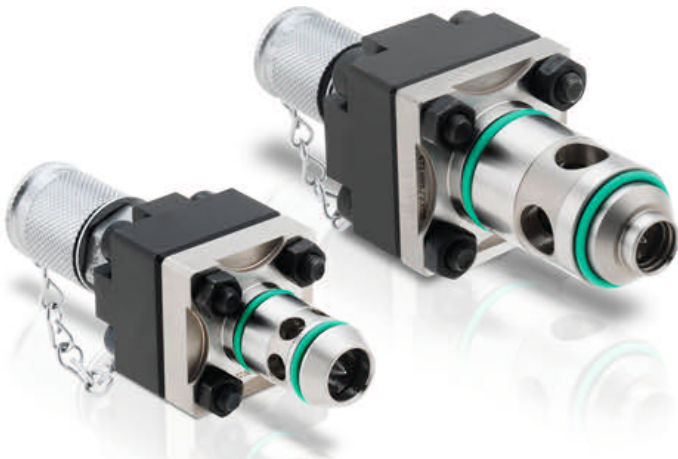
Bild 5. Flexibel punktet: Mit den patentierten Variodüsen lässt sich die Austragsmenge bei konstantem Druck und gleichbleibender Mischqualität während des Schusses verändern
