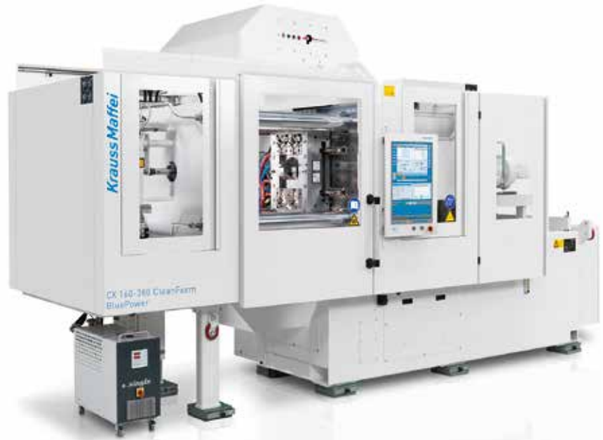
Bild 4. Produktion unter Reinraumbedingungen: Die Zweiplattenmaschine CX ist optional mit einer speziellen Flow Box über der Schließeinheit ausgestattet. Damit bleibt der Werkzeugbereich nahezu staubfrei (© KraussMaffei)
