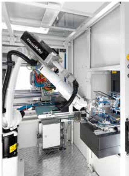
Bild 5. Kompakte Automation: Ein Sechsrhoboter legt die Bauteile in die Laser-Beschneidstation. Im Hintergrund zu sehen: das Förderband mit UV-Tunnel und dahinter die Schließeinheit mit Folienvorschub
