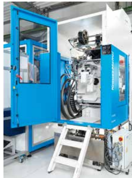
Bild 6. Die Zweiplattenmaschinen der CX-Baureihe nutzen die Aufstellfläche für das IMD-Verfahren sehr gut aus und gewährleisten mit der Auswerferöffnung eine gute Zugänglichkeit zu allen Komponenten
