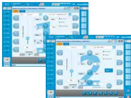
Leichte Unterscheidung des aktiven Roboters auf den Handfahrseiten
