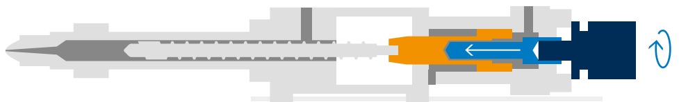
Das bewährte Inline-Aggregat und das innovative APC sorgen für äußerste Schussgewichtskonstanz.
