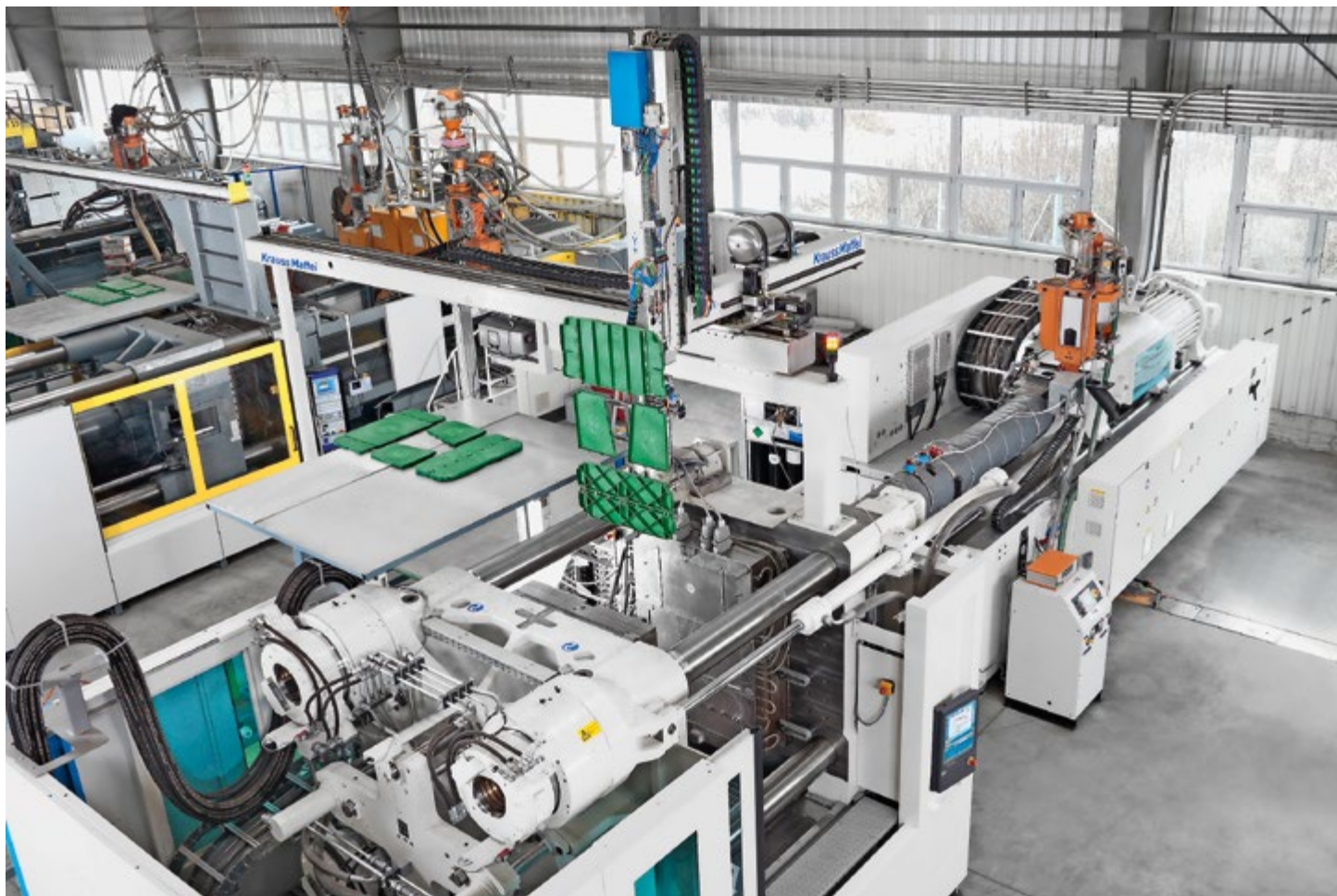
Auf der MX 1000-24500 mit 150-mm-Mucell-Schnecke und dem Handling LRX350 entstehen die Innenteile des Drei-Phasen-Komposters Aeroplus 6000. Fotos: Krauss Maffei
