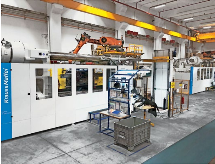
Insgesamt vier Krauss Maffei MX-Maschinen bilden das Fundament für die Stoßfängerproduktion bei A-Plas im modernen Werk in Bursa.
