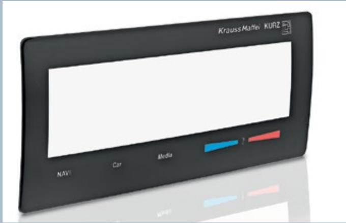
Funktion und Dekor in einem: Auf der Fakuma 2018 entstand auf einer PX 320 in einem Produktionsschritt ein komplettes, 10“ großes HMI-Display mit integrierter Elektronik, schwarzem Dekorrahmen und Kratzfestbeschichtung. Foto: Krauss Maffei
