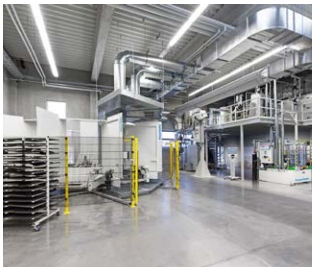
Maßgeschneiderte Systemlösung: Die KraussMaffei-Rundtischanlage bei Volz wird von einer Misch- und Dosieranlage der Baureihe RimStar Compact mit Material versorgt.
