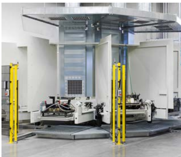
Maximale Flexibilität: Da auf den einzelnen Stationen unterschiedliche Bauteile gefertigt werden, muss die Anlage das jeweilige Werkzeug automatisch erkennen.
