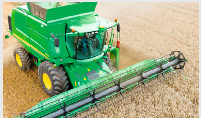
Das im LFI-PUR-Verfahren hergestellte zweiteilige Dach für einen Mähdrescher mit 2,4 x 2,2 m Außenmaß wiegt weniger als 23 kg
