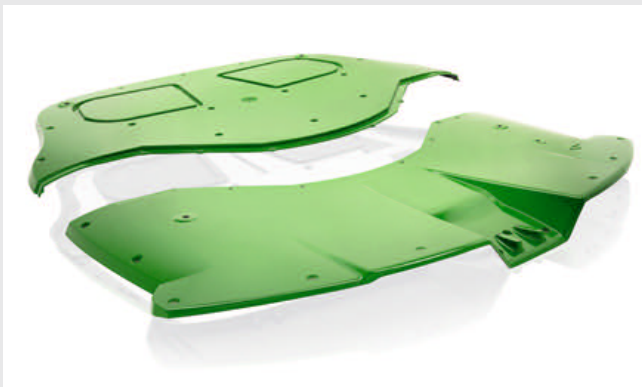
Das im LFI-PUR-Verfahren hergestellte zweiteilige Dach für einen Mähdrescher mit 2,4 x 2,2 m Außenmaß wiegt weniger als 23 kg
