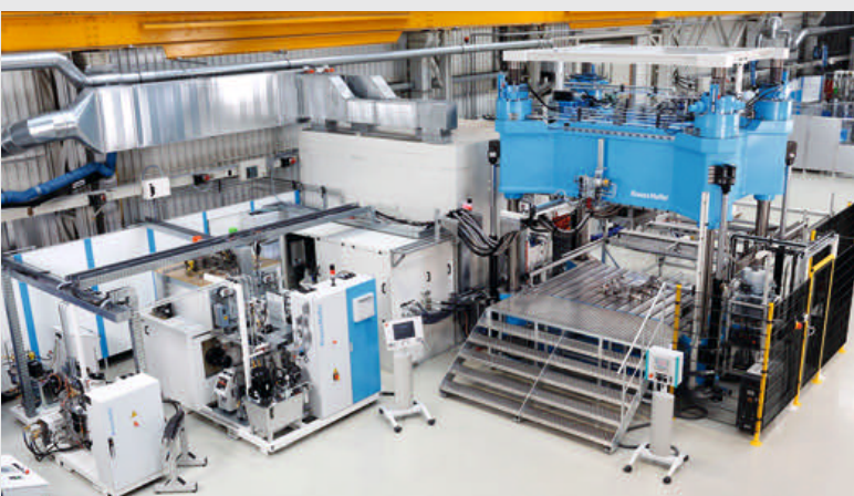
Labor-Produktionsanlage für das HD-RTM-Verfahren mit Dosiereinheit RimStar Thermo, HD-RTM-Mischkopf und Formträger SFT-MX600
