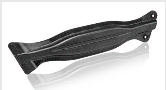
Zur Herstellung dieses Musterteils für einen Seitenaufprallschutz wurde ein Organblech mit einem faserverstärkten Polyamid hinterspritzt
