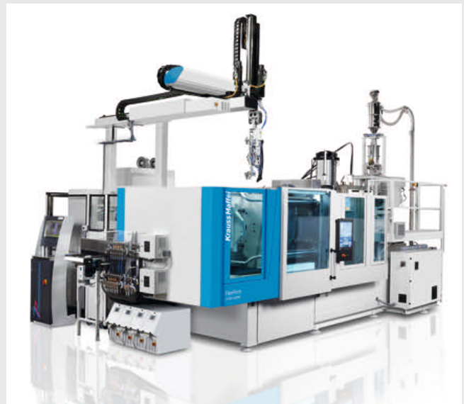
Die kompakte Fertigungszelle zum Um- und Hinterspritzen von Organblechen kommt mit einem Linearroboter aus und liefert einbaufertige Strukturbauteile
