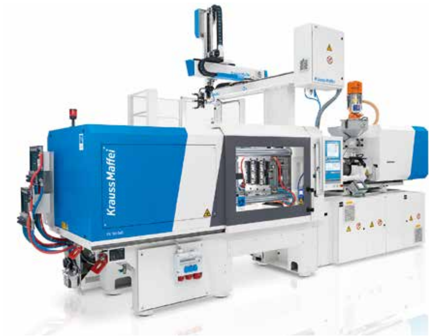
Bild 1. Mit den Premieren der PX25 und PX320 erweitert KraussMaffei die vollelektrische PX-Baureihe um neue Schließkraftgrößen nach unten und oben (© KraussMaffei)
