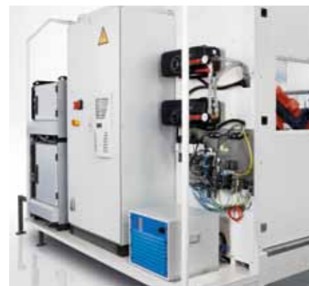
Technickrack auf Maschinen-Grundrahmen angeordnet (Mobilität)
