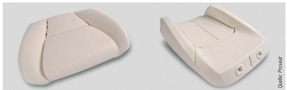
Abb. 1: Sitzkissen und Rückenlehnen mit unterschiedlichen Härtezonen gewährleisten ein Höchstmaß an Komfort und Stabilität
