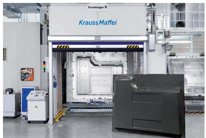
Abb. 1: Parat nutzt die neue LFI-Anlage zur Produktion großformatiger Bauteile mit einer Fläche von mehreren Quadratmetern
