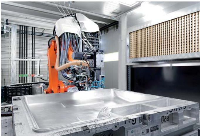
◀ Abb. 2: Um auch bei großflächigen Bauteilen komplexe Geometrien realisieren zu können, wird die LFI-Einheit der neuen Anlage von einem Sieben-Achs-Roboter geführt
