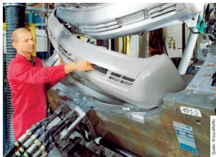
Abb. 1: Anfang der 1970er Jahre revolutionierte der R-RIM Prozess die Herstellung von Automobil-Stoßfängern. Auf der K1992 stellte KraussMaffei diesen Prozess in Kombination mit dem In-Mold-Coating (IMC) vor
