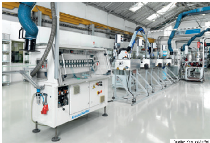
◀ Abb. 10: Mit der neuen iPul-Pultrusionsanlage führte KraussMaffei 2017 die erste Komplettanlage für das Pultrusionsverfahren in den Markt ein
