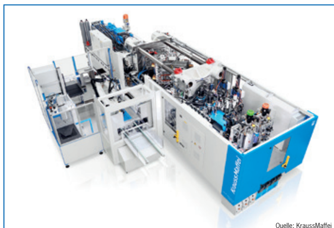
Abb. 7: Synergien aus Spritzgießprozess und Reaktions-technik: Der ColorForm-Prozess zur Herstellung hochglänzender kratzbeständiger Oberflächen
