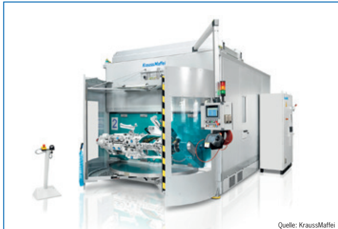
◀ Abb. 8: Der für die Beschnitttechnik zuständige Standort Viersen liefert neben dem konventionellen Stanzen auch die flexiblen Verfahren als robotergeführte Fräs- und Kaltmesser-Lösungen
