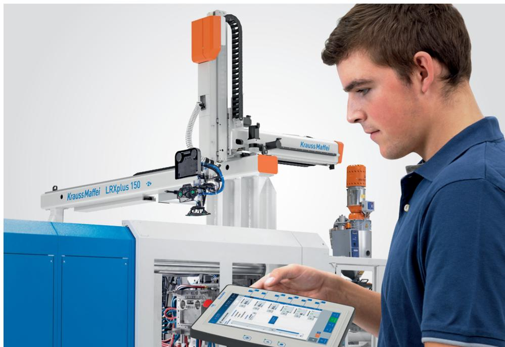
*Neues, ergonomisch optimiertes Handheld mit Touchscreen-Funktion und Hardkeys zum komfortablem Programmieren und Einrichten des Linearroboters LRXplus*
