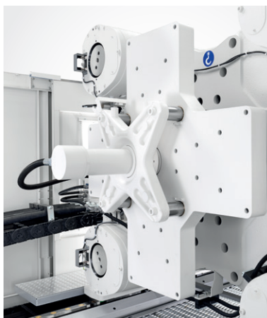
Der großzügige Auswerferbereich ist auch für Sonderauswerfer oder Drehtische geeignet
