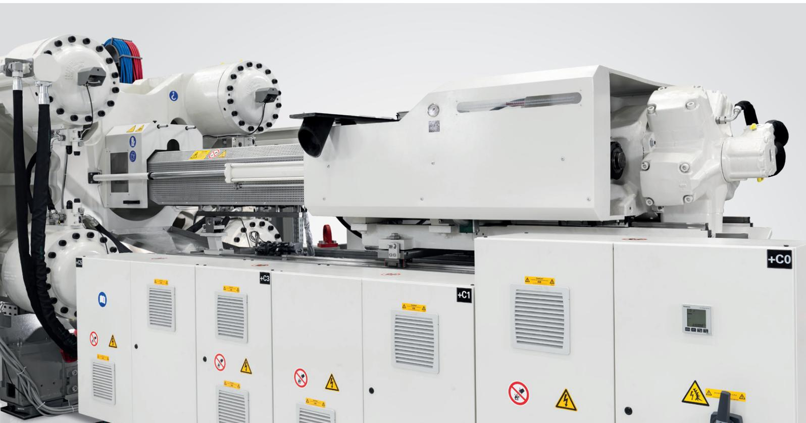
Das Plastifizierungskonzept der powerMolding liefert während des Aufschmelzprozesses eine ausgezeichnete Schmelzequalität für eine Vielzahl von Kunststoffen. Die Schnecken entsprechen den Standards von KraussMaffei und bieten verschiedene Geometrien, um optimale Ergebnisse je nach Anwendung und Material zu erzielen.
